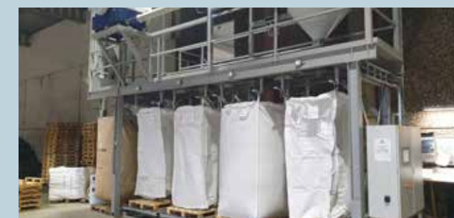
Storsäckar fylls med plastflakes för vidare transport ut till tillverkningsindustrin.
